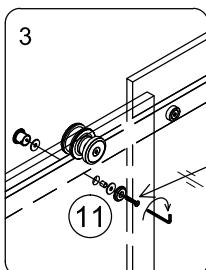
**\*\*\*Appliquer de la colle "Loctite" sur le filetage des vis des Anti-sauts avant l'installation.\*\*\***
